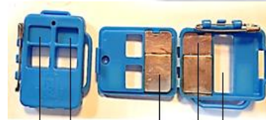
شکل ۳- تصویر بچ جنس و ضخامت فیلترها: ۱- پنجره باز ، ۲- 1mmDural ۳- 0.7mmSn+0.3mmPb ۴- 50mmgr/cm2 ۵- 300mmgr/cm2
